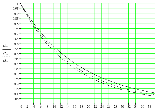
Рис. 3. Зависимость величины \varepsilon потери энергии от числа n соударений гранул
