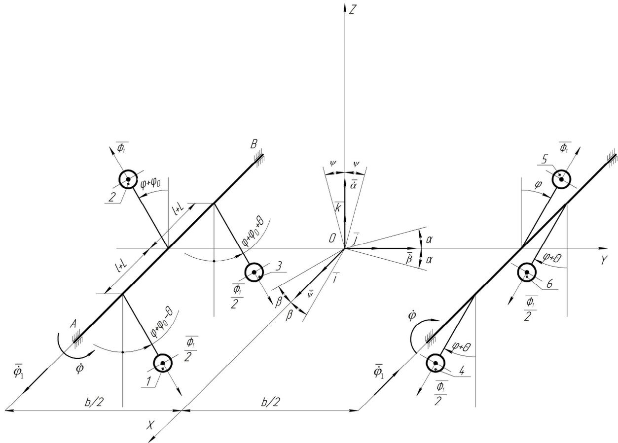
Рис. 1. Расчетная схема блока управляемых виброизбудителей
