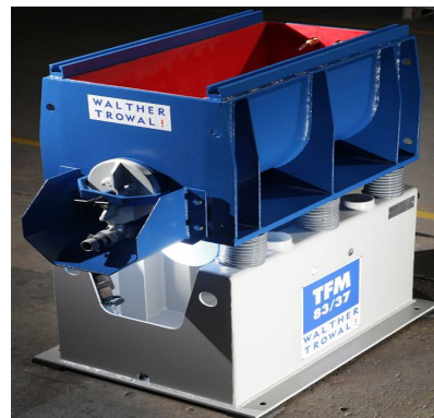
Рис. 2. Однокамерна універсальна неавтоматизована ВТМ загального призначення фірм SPALECK Oberflächentechnik та WaltherTrowal
