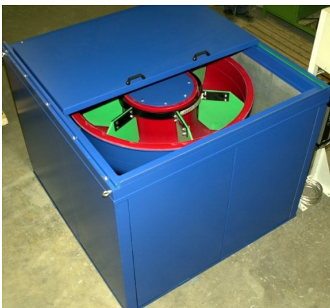
Рис. 3. Багатокамерні універсальні неавтоматизовані ВТМ загального призначення фірми Walther Trowal
