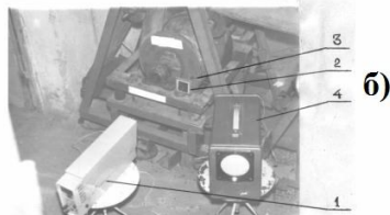
Рис. 3 Вібровимірвальна апаратура для проведення експериментальних досліджень а) вібровимірвальна апаратура “Robotron”; б – апаратура для вимірювання амплітуди та траєкторії коливань: 1 – лазер; 2 – датчик; 3 – мітка на робочому контейнері; 4 – осцилограф
