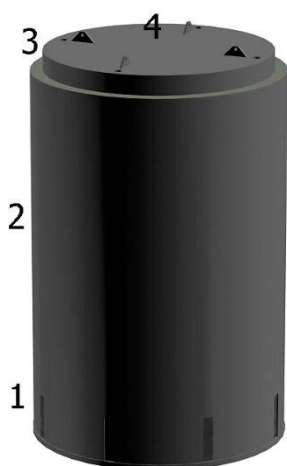
Рис. 5. Розташування точок розрахунку потужності дози для контейнера HI-STORM 190.
