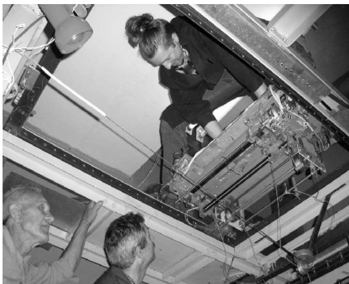
Рис. 2. Устройство позиционирования образцов в процессе монтажа на экспериментальной установке ИЯИ НАН Украины
