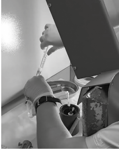
Рисунок 4 – Розбавлення ^{18}\text{F} -ФДГ розчином NaCl та встановлення шприца в захисний кожух
