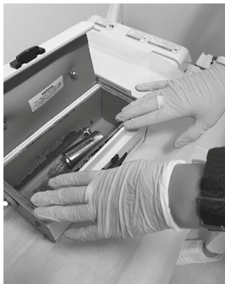
Рисунок 1 – Вкладання ММС шприца з ін'єкцією – призначеною дозою РФП захисному кожусі до спеціального переносного захисного контейнера
