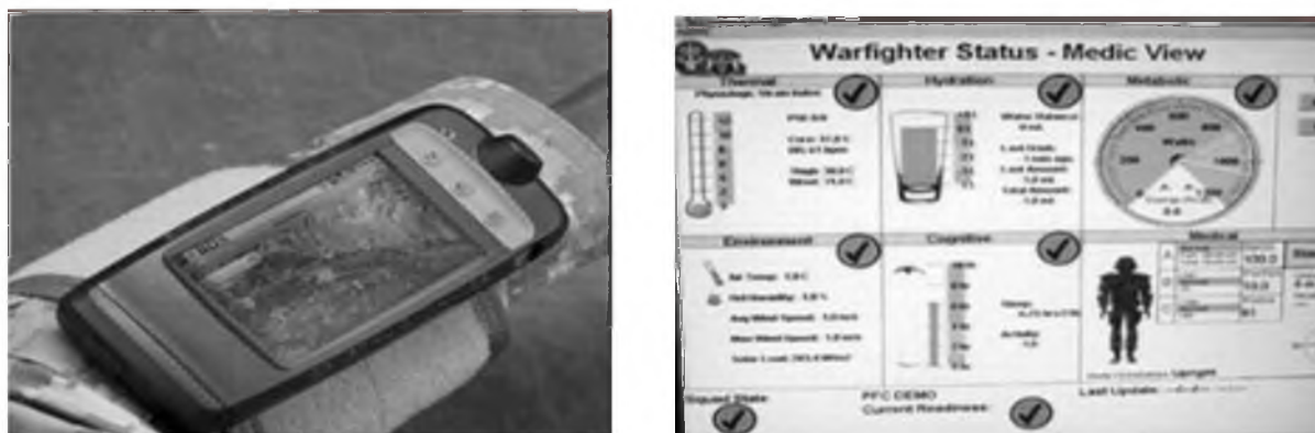
а) зовнішній вигляд пристрою моніторингу фізіологічного стану WPSM; б) варіант відображення інформації програмним забезпеченням.
