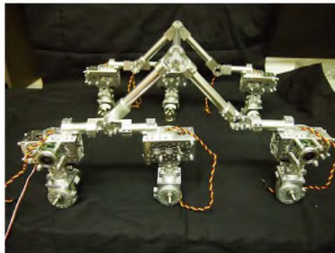
Рис. 3. Тягові електродвигуни з системою перетворювачів для шестиколісної платформи розробки НАСА
