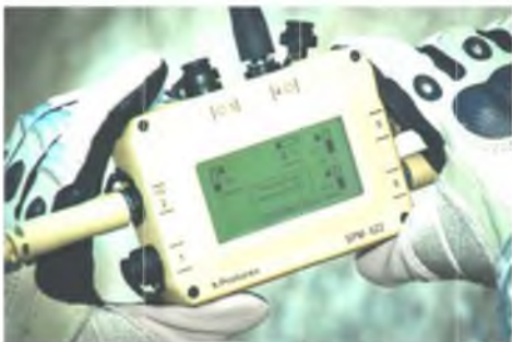
Рис. 3. Багатоportовий диспетчер електроживлення Squad Power Manager 622
