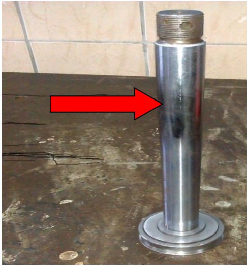
Рисунок 4 – Следы перекала металла - следы почернения в рабочей зоне перемещения штока были обнаружены при разборке гасителя типа 677000
