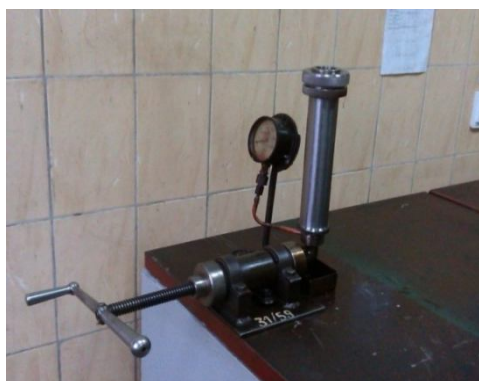
Рисунок 2 – Технологическое устройство для проверки и регулировки величины давления срабатывания перекрывающего клапана, изготовлено самими работниками депо
