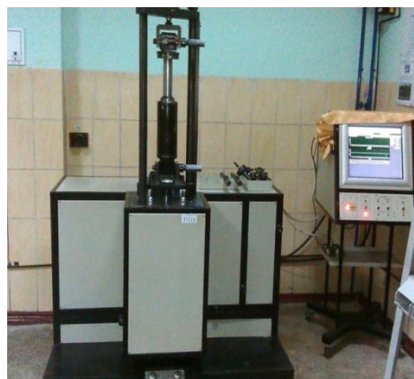
Рисунок 3 – Стенд марки «ИГК-90.1» для испытаний гасителей после ремонта (2011 года выпуска, производство Украина, производитель ЧМП «КОМПРО»)
