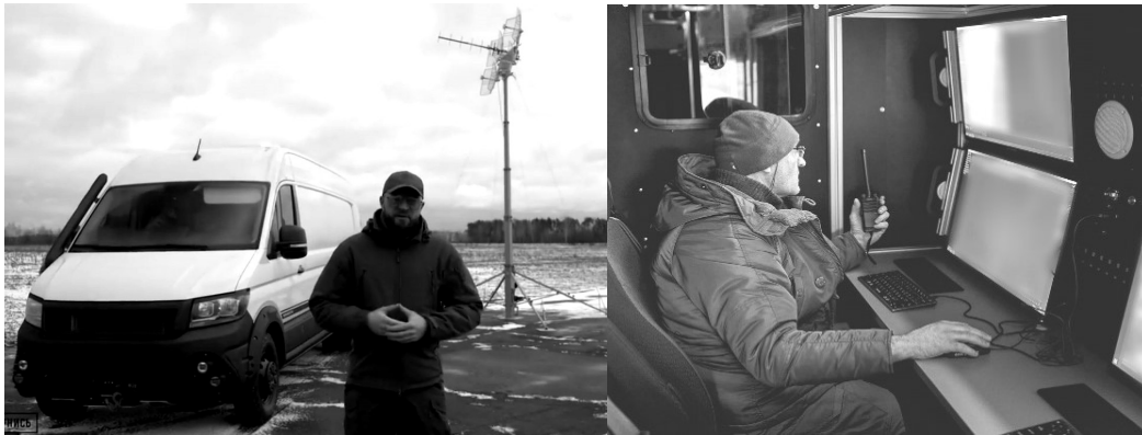
Рисунок 1 – Комплекс управління БПЛА на базі повнопривідного автобуса Terrastorm від Torsus [3]
