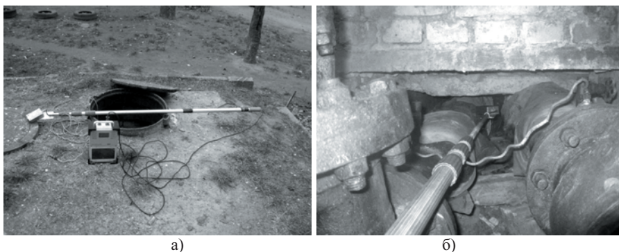
Рис.1. Зонд для внутриканального обследования теплотрасс
