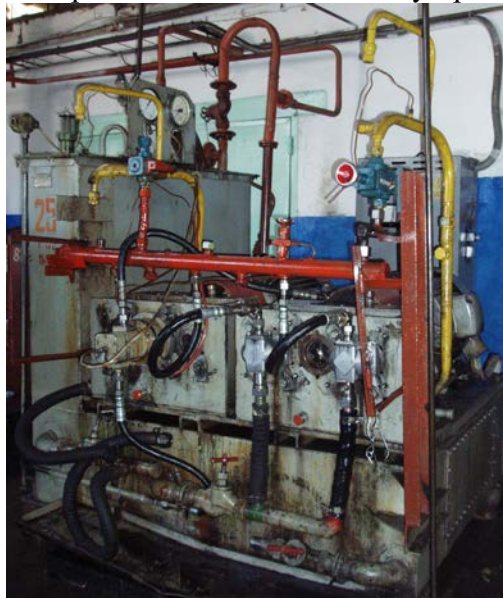
Рисунок 1 – Загальний вид стенду СИН – 36 для ресурсних прискорених випробувань шестеренного насоса
