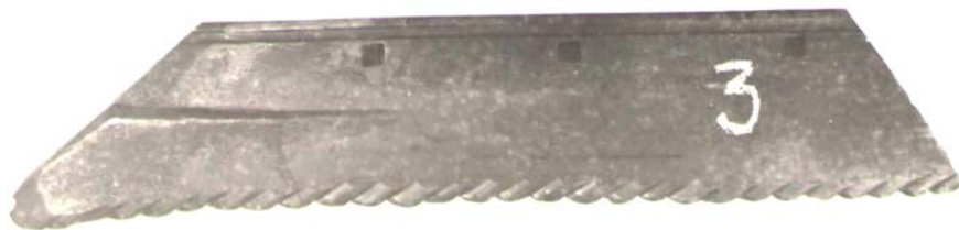
Рисунок 2 - Леміш плуга після наробітку 49,0 га
