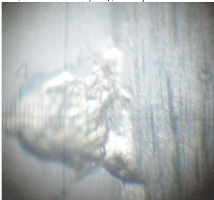
Рисунок 4 – Фотографии начала усталостного разрушения дорожки внутреннего кольца подшипника
