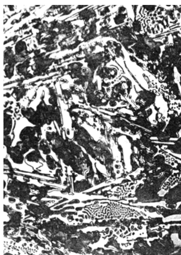
Рисунок 2 – Мікроструктура білого чавуну (0,81% Cr) \times 500
