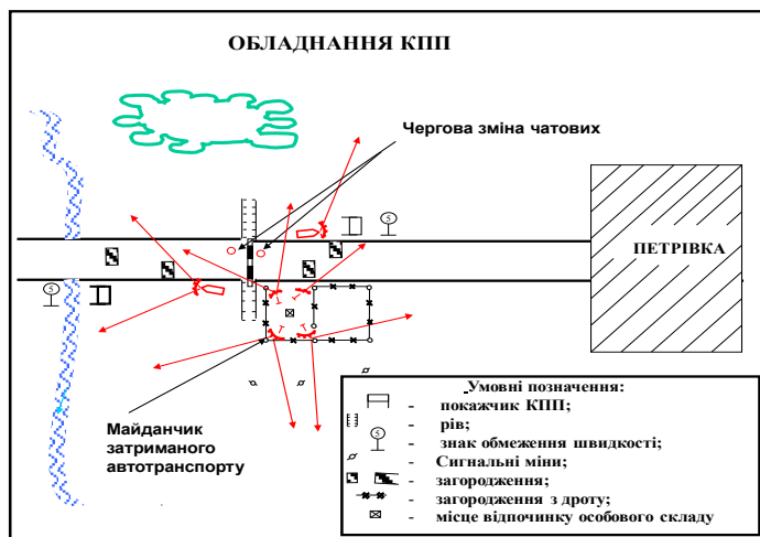
Рис. 1. Інженерне обладнання контрольно-пропускового пункту
