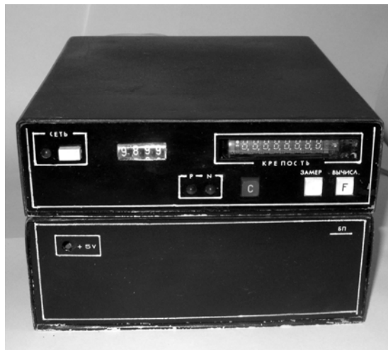
Рис. 2. Загальний вигляд електронного приладу для вимірювання міцності і тріщинуватості гірничих порід
