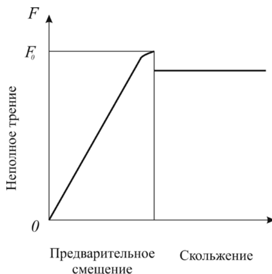
Рис. 2. Значение силы трения в зависимости от относительного смещения трущихся тел при сдвиге (сцеплении), переходящем в скольжение.
