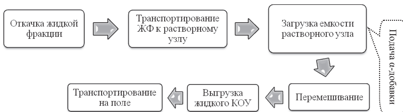
Рис. 1. Технологическая схема процесса производства жидких КОУ на основе полужидкого навоза КРС
