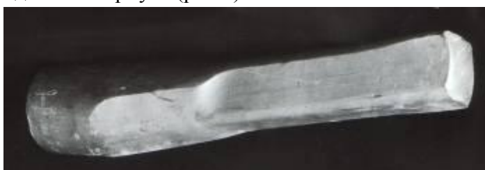
Рис. 2. Вальцьована заготовка зі сплаву АК6.
