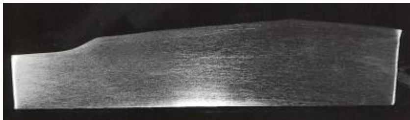
Рис. 6. Поздовжній переріз штампованої поковки деталі «Корпус».
