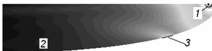
Рис. 6. Контурная картина потока излучения, отраженного от участка зеркального отражателя
